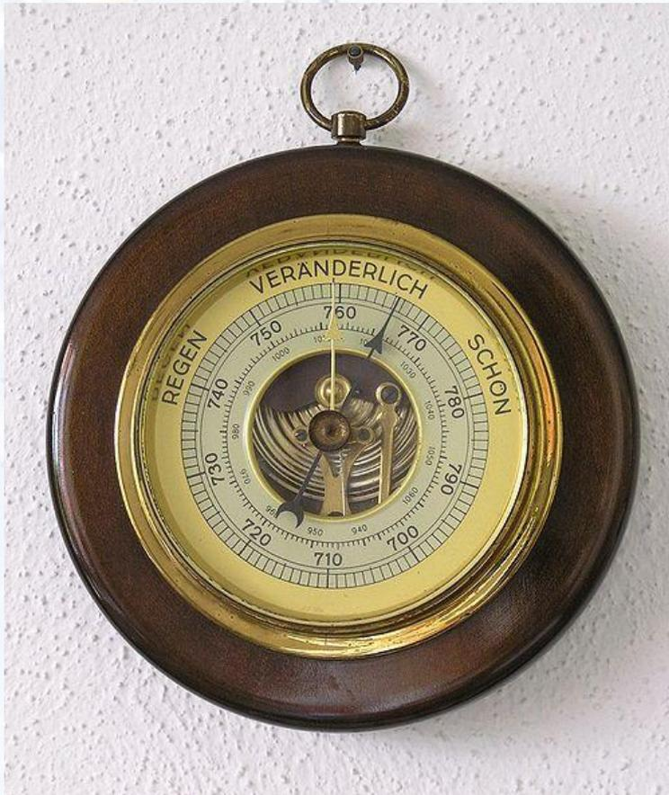
**Барометр** (др.-греч. βάρος — «тяжесть» и μετρέω — «измеряю») — прибор для измерения атмосферного давления. Ртутный барометр был изобретён итальянским учёным Эвангелиста Торричелли в 1644 году.
