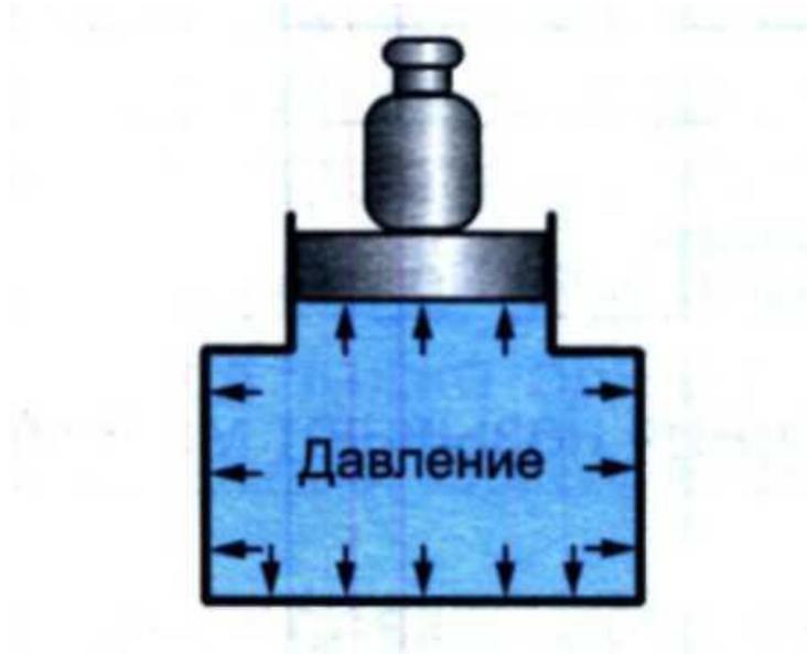
Рис. 1.1. Иллюстрация действия закона Паскаля
