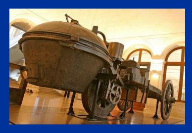
Повозка была грубой формы и предназначалась по замыслу ее создателя для перевозки артиллерии. У нее имелось три колеса, из которых одно впереди, ведущее и одновременно рулевое. Только вода и топливо, необходимые для движения, весили целую тонну.
