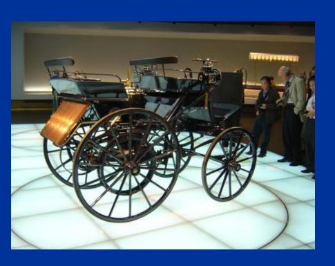
Цилиндр располагался горизонтально над осью огромных задних колес и приводил их в движение через одну ременную и две цепные передачи. Большой, горизонтально расположенный маховик находился под двигателем. Он соединялся с коленвалом конической передачей и использовался для создания равномерного вращения и для запуска мотора.
