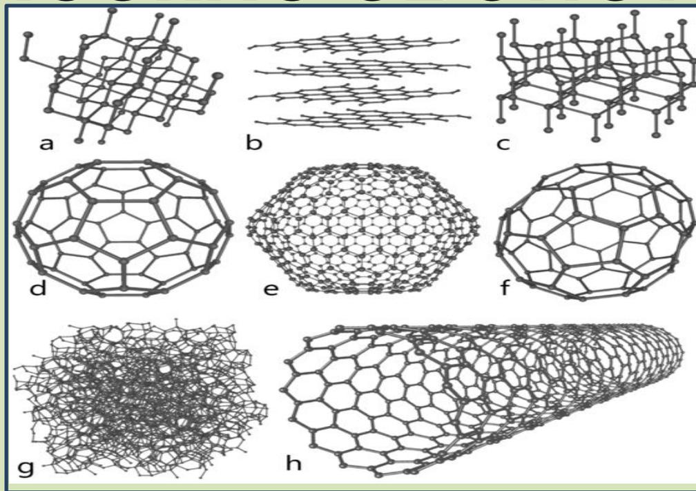
Схемы строения различных модификаций углерода
