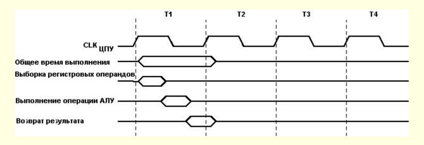
Этапы конвейерного выполнения команд в AVR-микроконтроллерах
