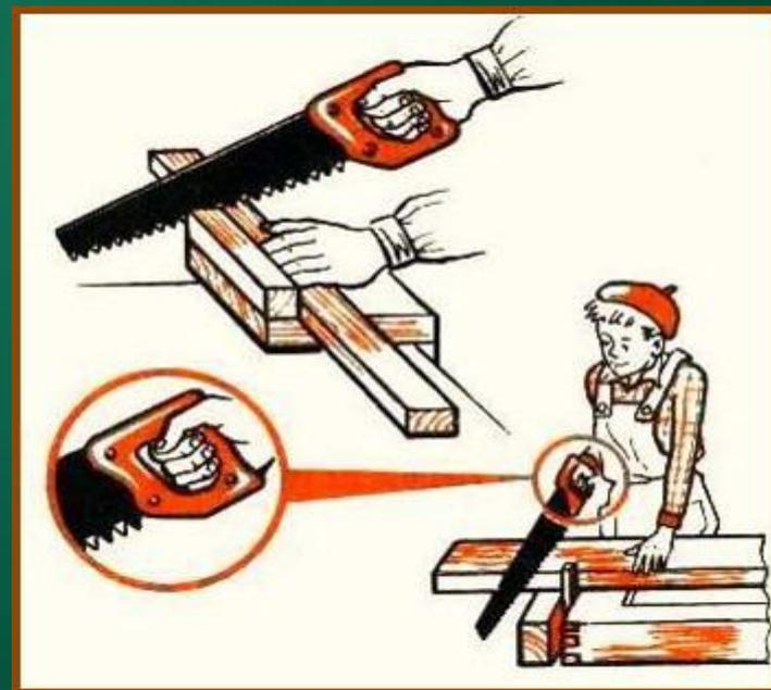
При пилении полотно пилы трется о стенки отделяемых частей древесины. И чтобы его не зажимало в пропиле, зубья пилы должны быть разведены, т. е. поочередно отогнуты в разные стороны. Благодаря этому пропил становится немного шире и пиление облегчается.
