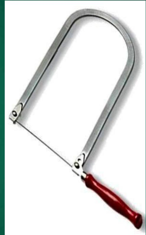
*Рама лобзика должна быть упругой, так как в обратном случае она не сможет обеспечить достаточное натяжение полотна.*
