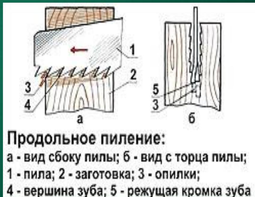
Для смешанного пиления применяют пилы с комбинированными зубьями в виде прямоугольных треугольников с углами заострения  $50... 60^\circ$  или с небольшой расточкой в  $75-80^\circ$  в зависимости от твердости древесины. Меньший угол заострения берут при пилении мягких пород древесины, больший — для твердых пород. Величина угла резания у зубьев для смешанного пиления —  $90^\circ$ .
