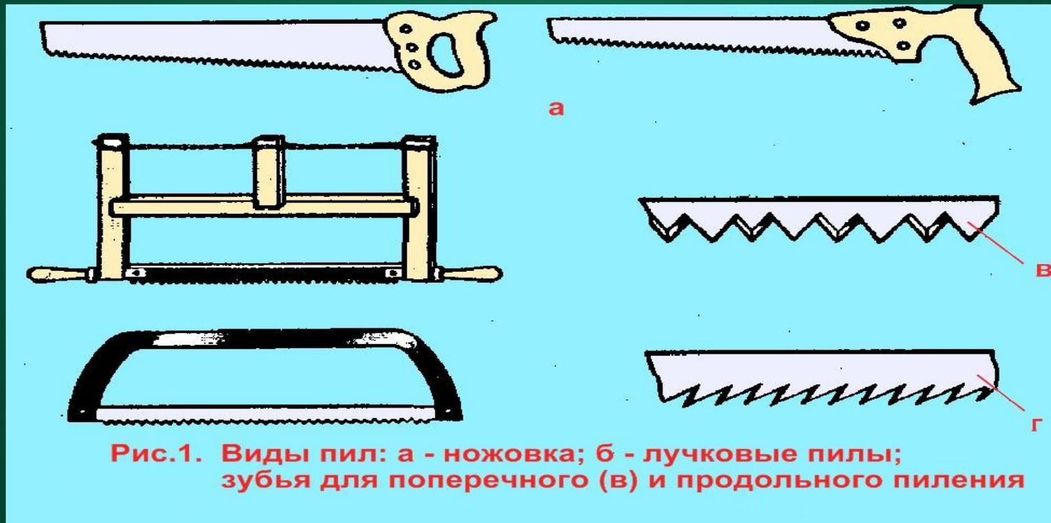
**Рис.1. Виды пил: а - ножовка; б - луковые пилы; зубья для поперечного (в) и продольного пиления (г)**
