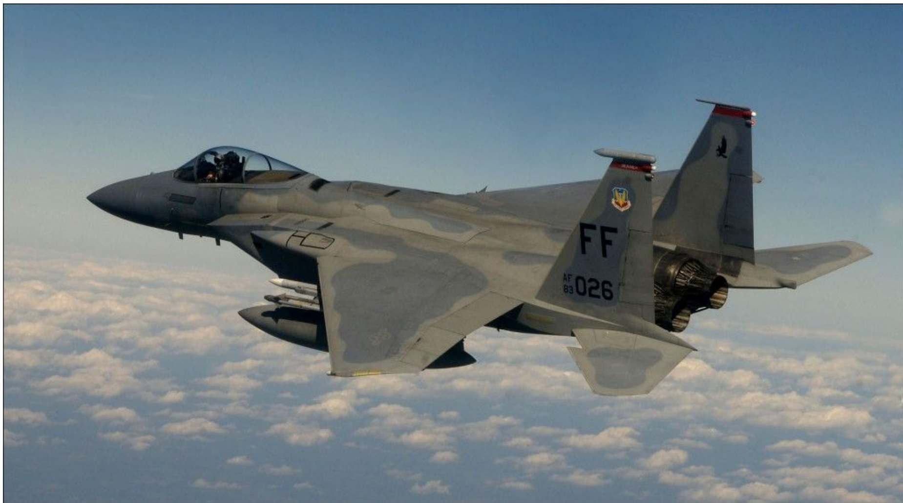
Истребитель F-15 с двигателями F100-PW-229 со смешением потоков
