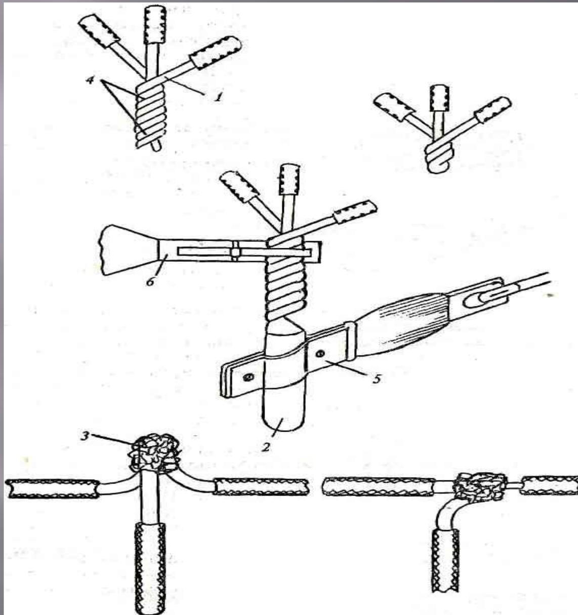
Рис. 139. Соединение проводов скруткой:
