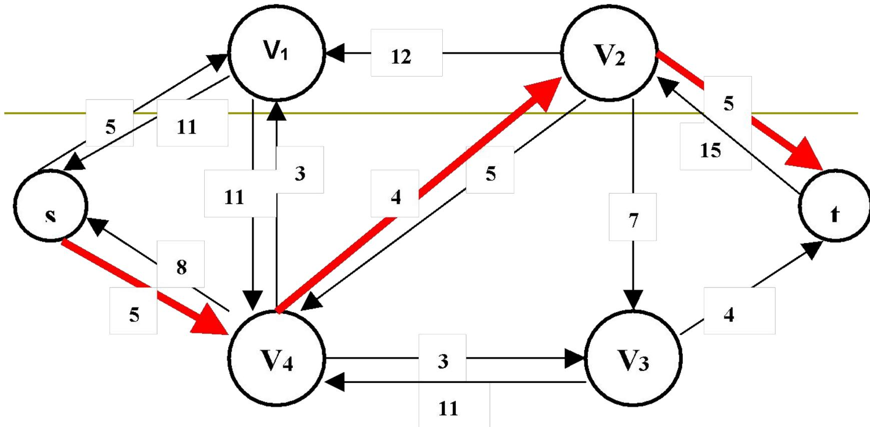
**Б) Остаточная сеть  $G_f$ .** Выделен дополняющий путь  $p$ . Его остаточная пропускная способность  $c_f(p)$  равна  $c(v_2, v_3)=4$
