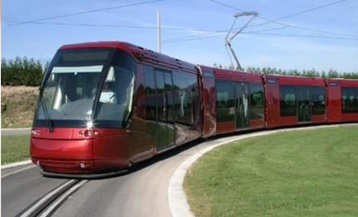
Трамвай, использующий один рельс в качестве направляющей.
