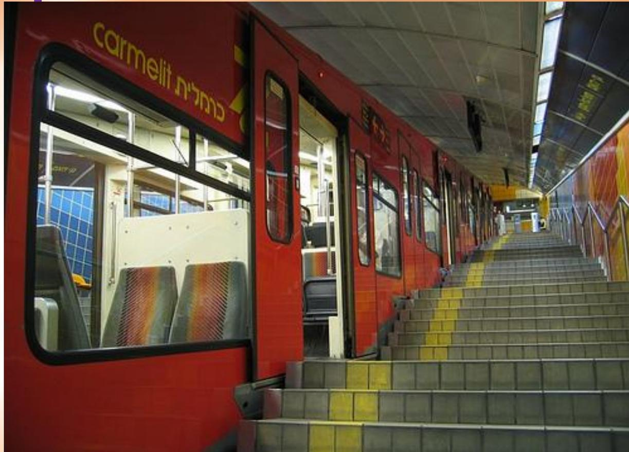
Кармелит - система сочетающая черты метрополитена (потому что подземная) и фуникулера (потому что выполняет функции для крутого подъема) в городе Хайфа. Самый чудной из фуникулеров.
