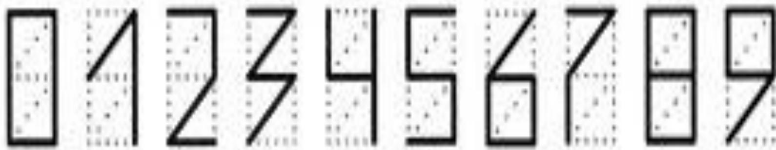
Это изображение цифр связано с потребностями техники. Это цифры, записываемые на обороте почтового конверта. Цифры предназначены для электронной машины, сортирующей корреспонденцию.
