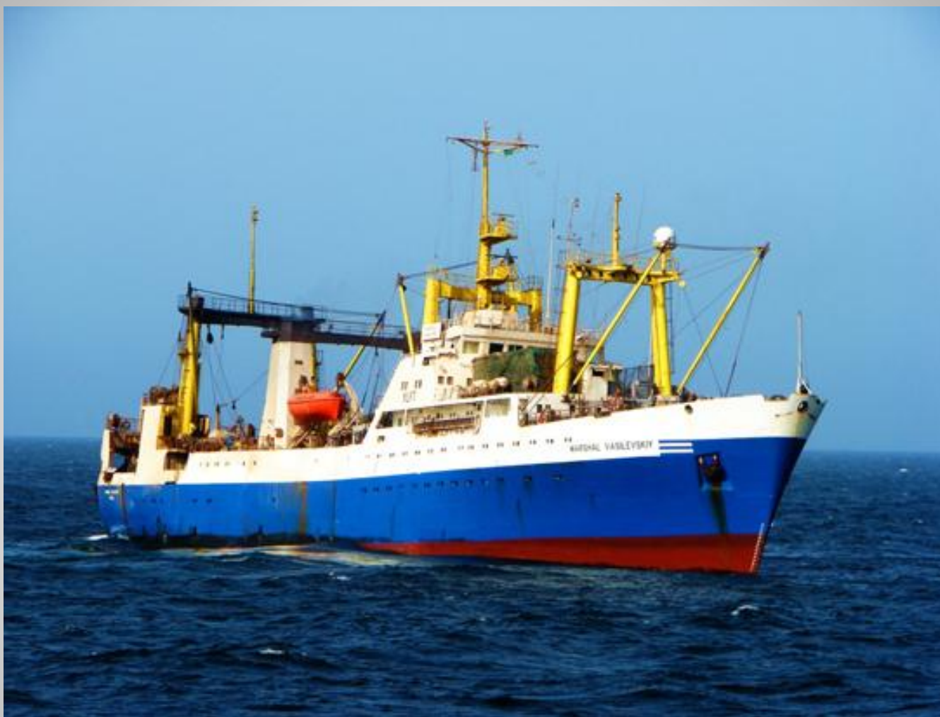
БАТМ «Маршал Василевский» (порт приписки — Лиепая, ранее Калининград)- большой автономный траулер. Назначение судна – ловля, переработка и заморозка рыбы.
