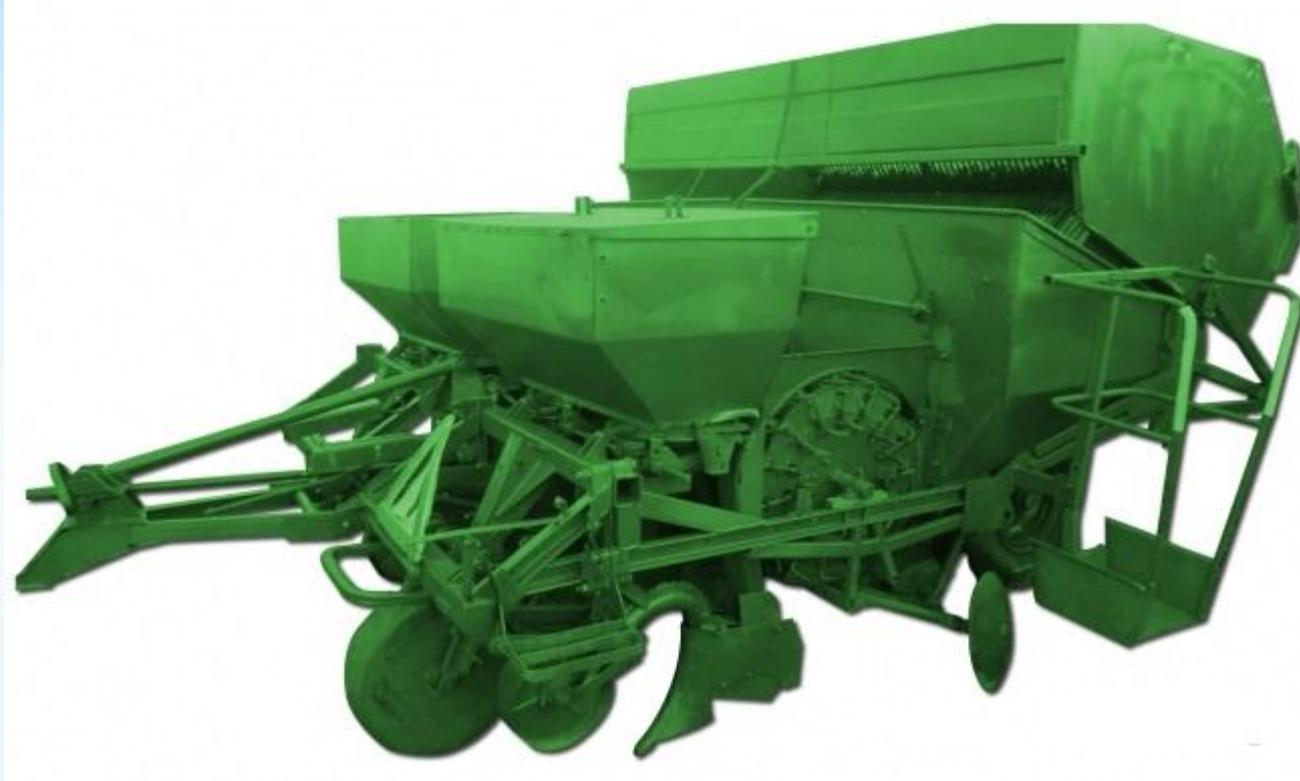
\* Полунавесная четырёхрядная картофелесажалка КСМ-4 создана для посадки не пророщенных клубней. Картофелесажалку агрегатируют с тракторами тягового класса 1,4 и 3. Ширина образуемых междурядий составляет 70 см. Расстояние между клубнями регулируется в пределах 19-44 см. Способна работать на повышенных скоростях 6-9 км/ч
