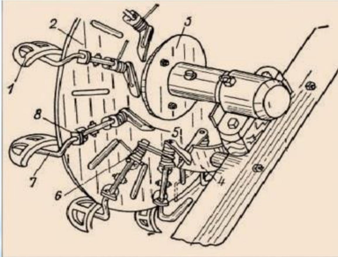
\* 1 ложечки, 2 барабан, 3 ступица барабана, 4 отклоняющая шина, 5 рычаг отклоняющего механизма, 6 пружина, 7 прижимной палец, 8 проушина крепления механизма
