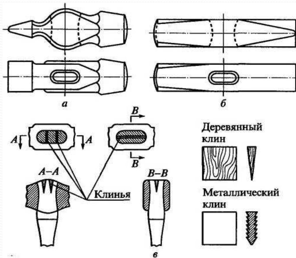
Молотки слесарные: а - с круглым бойком; б - с квадратным бойком; в - способы крепления ручки
