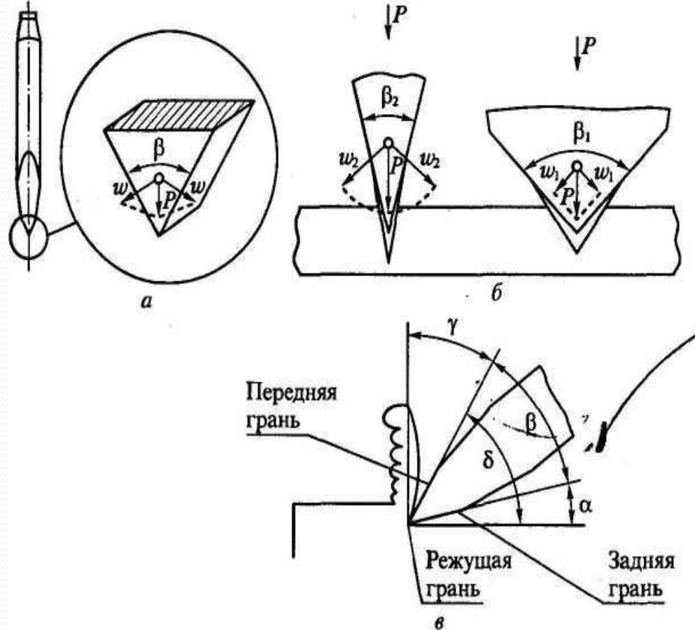
**Слесарное зубило** состоит из трех частей: рабочей, средней, ударной. Как и при любой обработке резанием, режущая часть инструмента представляет собой клин.
