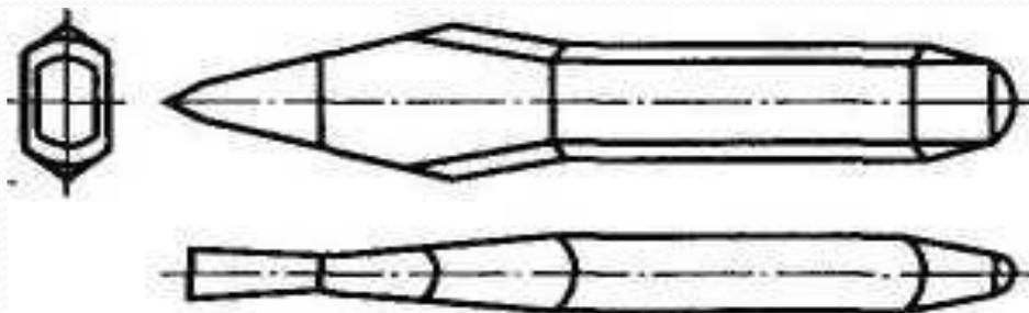
**Канавочник** применяется для вырубания смазочных канавок во вкладышах и втулках подшипников скольжения и профильных канавок специального назначения.
