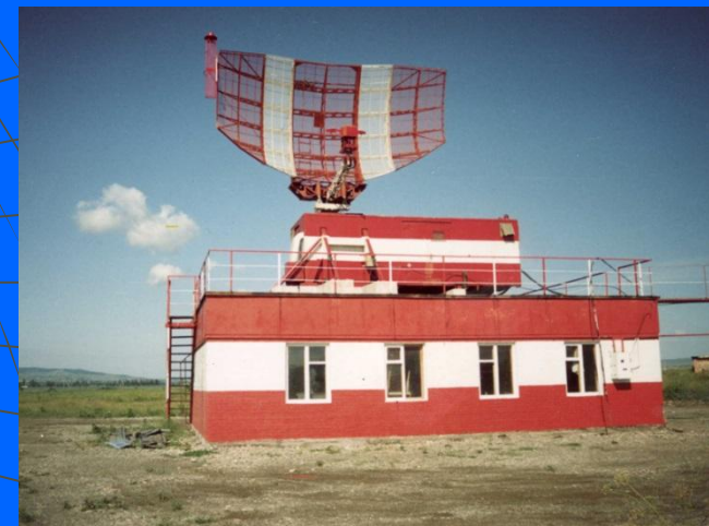
Аэродромно-обзорный радиолокатор (АОРЛ-85)
