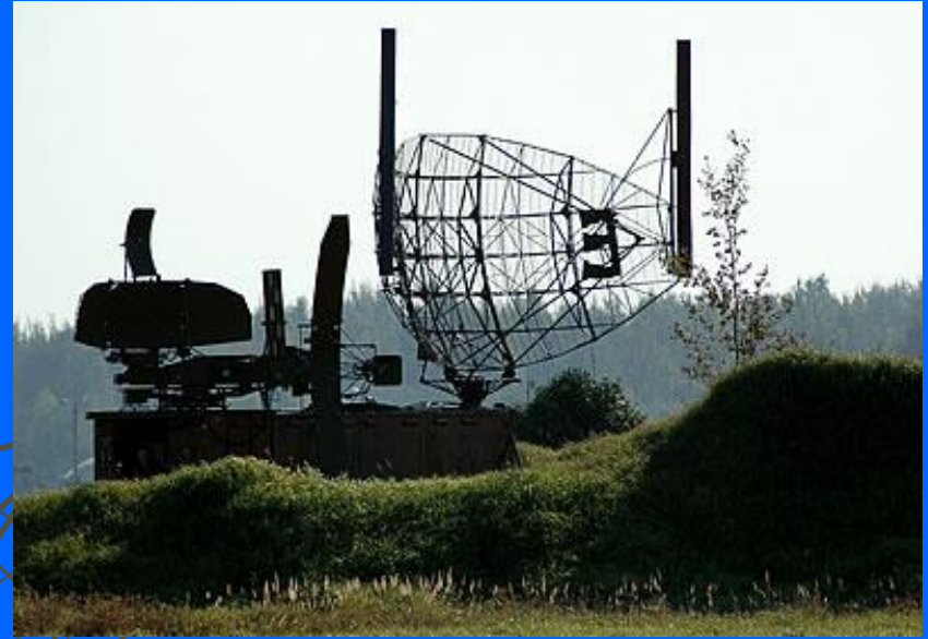
Радиолокационная система посадки РСН - 6
