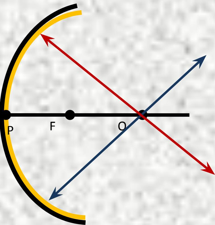
Лучи, проходящие через оптический центр зеркала после отражения опять идут через оптический центр
