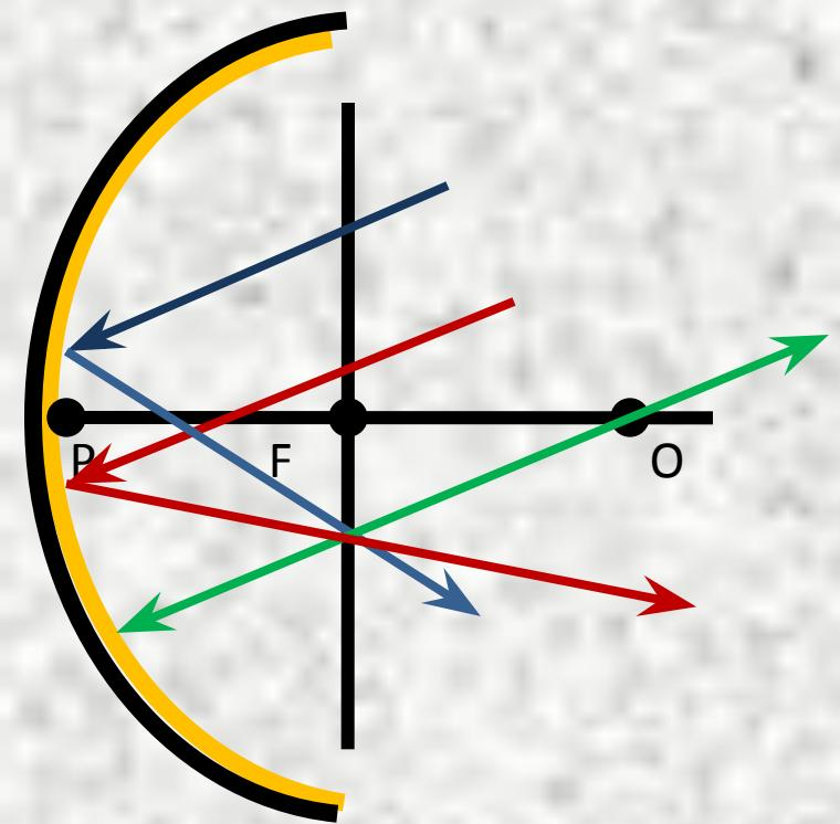
Параллельные лучи, падающие на зеркало под произвольными углами к главной оптической оси, после отражения пересекутся в одной точке, лежащей на фокальной плоскости.
