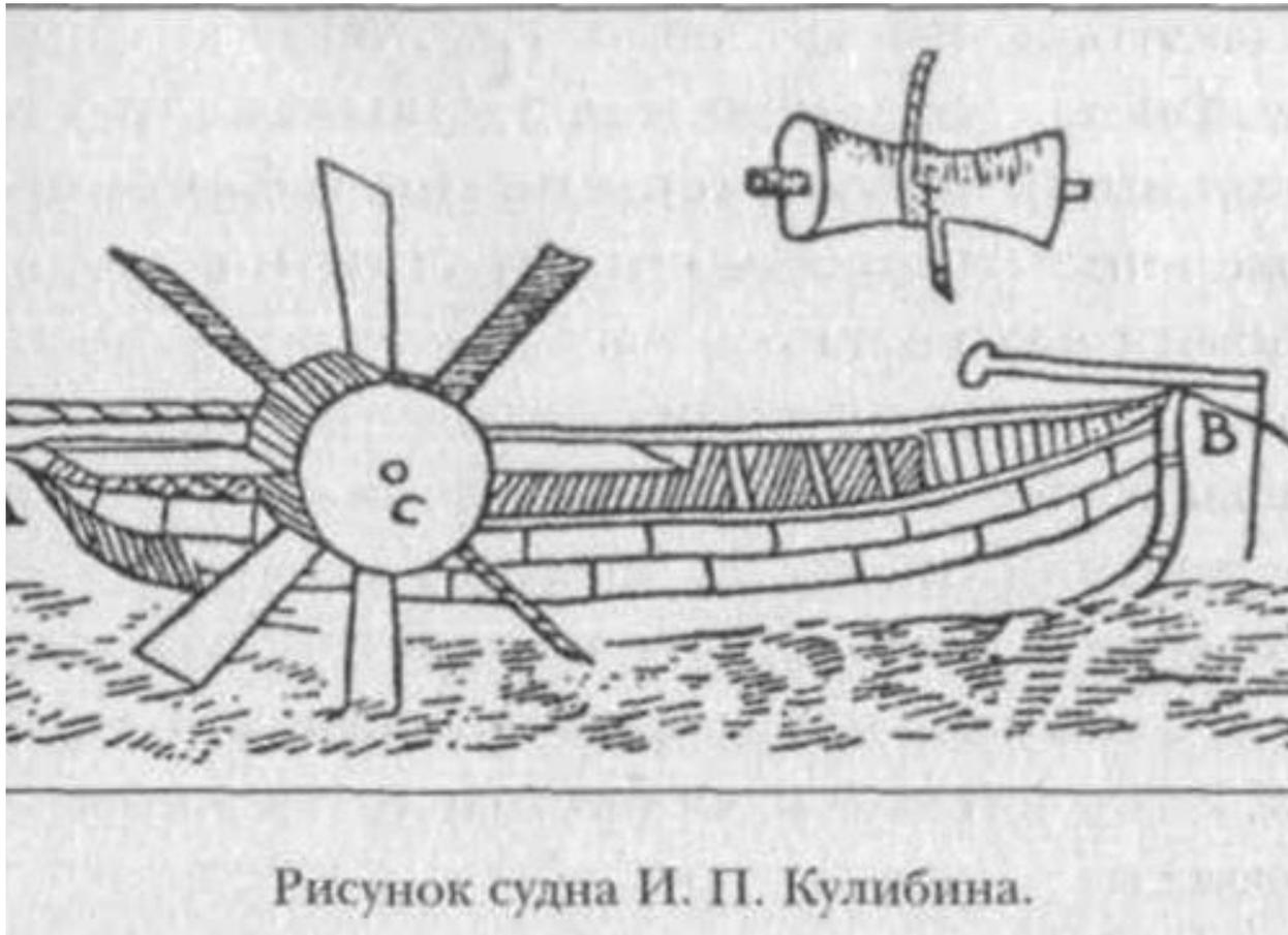
Изобретение представляло собой судно, приводимое в движение течением реки, по которой оно шло. Механизм работал так, что течение реки заставляло двигаться водяные колеса, установленные на судне.
