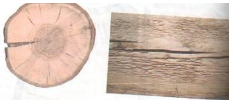
Рис. 12. Трещины древесины при несоблюдении правил сушки
