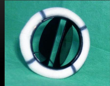
корпус протеза покрыт окисью титана, обеспечивающем высокую износоустойчивость и биологическую инертность. Большая высота поворотного механизма предотвращает заклинивание створок тканями сердца и позволяет увеличить угол открытия створок до 90 градусов.
