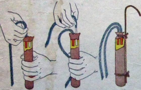
при длине зажигательных трубок более 4 м в патрон ВВ вводят две зажигательные трубки одинаковой длины
