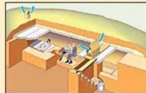
Быстровозводимое противорадиационное укрытие из железобетонных плит
