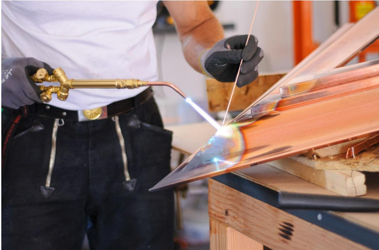
Газовую сварку применяют при изготовлении и ремонте изделий из тонколистовой стали толщиной 1-5 мм (для сварки больших толщин падает производительность), монтаже труб малого и среднего диаметров, сварке соединений и узлов, изготовляемых из тонкостенных труб, сварке изделий из алюминия и его сплавов, меди, латуни и свинца, сварке чугуна с применением в качестве присадки чугунных, латунных и бронзовых прутков, наплавке твердых сплавов и латуни на стальные и чугунные детали.
