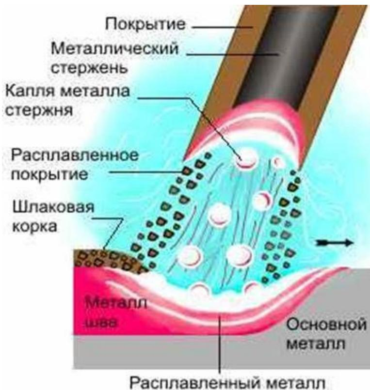
Электрод состоит из электродного стержня и электродного покрытия. Стержень – сварочная проволока; электродное покрытие – многокомпонентная смесь металлов и их оксидов. По функциональным признакам компоненты электродного покрытия разделяют:
