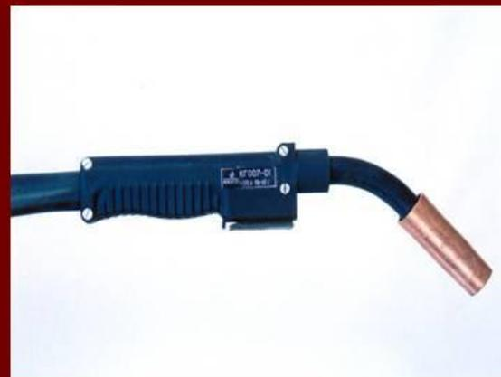
Горелка для полуавтоматической сварки плавящимся электродом:
