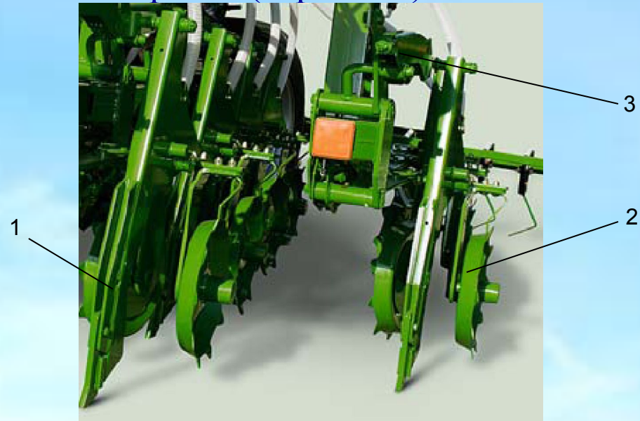
1-долотообразный сошник; 2-каток; 3-параллелограммный механизм
