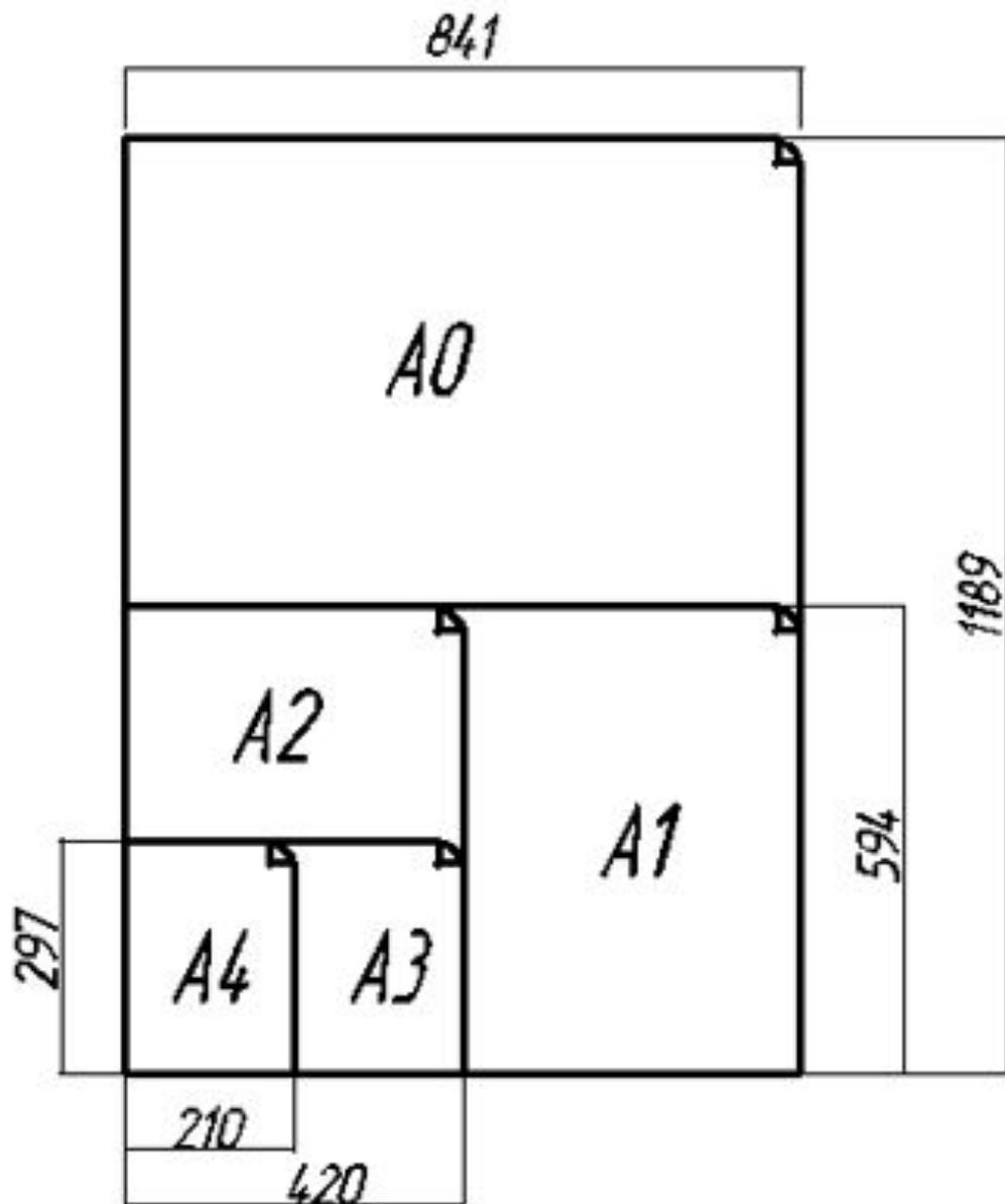
Чертежи выполняются на листах бумаги определенного формата (размера). Формат размером 1189X841 мм считается наибольшим из основных форматов. Остальные основные форматы получаются путем последовательного деления предыдущего большего формата на две равные части, параллельно его меньшей стороне
