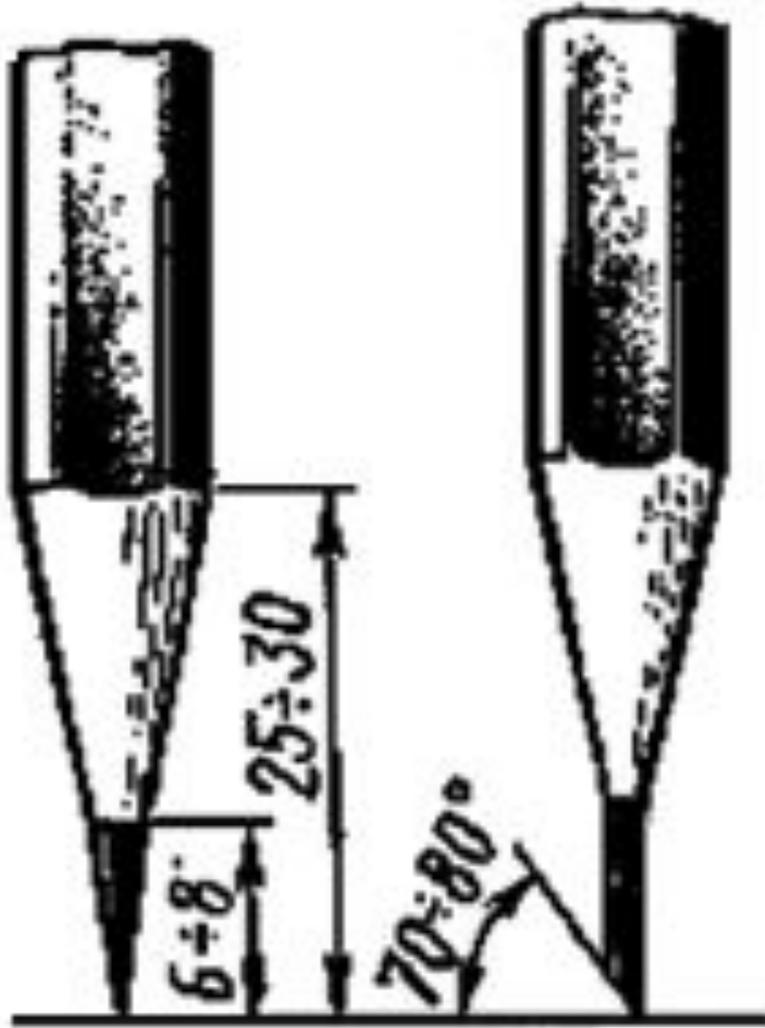
Заточку карандашей следует производить на конус или "лопаточкой". Карандашом, заточенным на конус выполняют штрихпунктирные линии, линии чертежа до обводки, делают надписи на чертеже.
