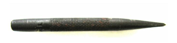
**Кернер** — инструмент в виде заострённого стержня из закалённой стали; служит для намётки (накернивания) точек (кернов) при подготовке к испытанию разрывных образцов или разметке заготовок, предназначенных для дальнейшей обработки.
