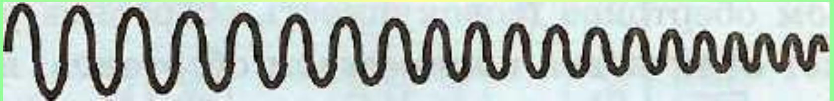
След камертона с более высоким звуком
