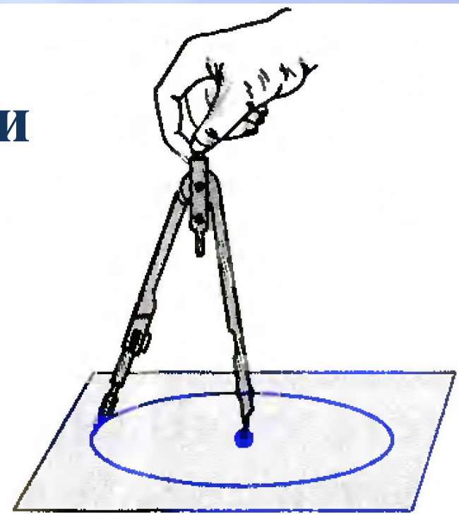
Построение окружности с помощью циркуля
