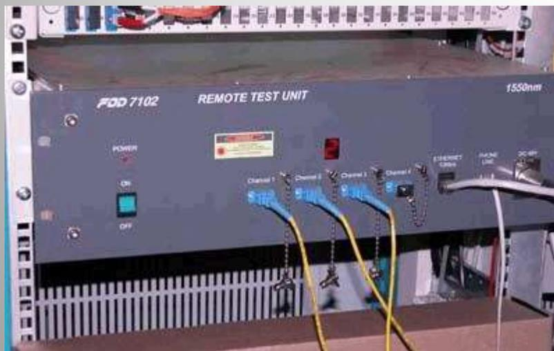
Все функции могут быть включены с удаленного компьютера. Оператор может сравнивать файлы из архива или другого рефлектометра, сохранять и архивировать изображения, автоматически находить события, изменять их.
