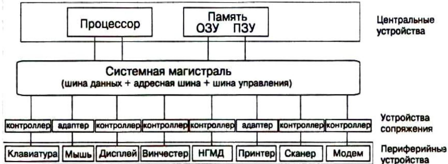
Схема архитектуры ПК, основанной на магистрально-модульном принципе
