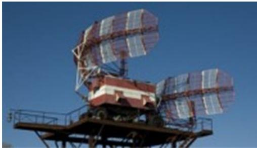
Двухкоординатная радиолокационная станция кругового обзора "Лира-1" (1Л118) разработана в процессе коренной модернизации радиодальномера 1РЛ139 (П37).
