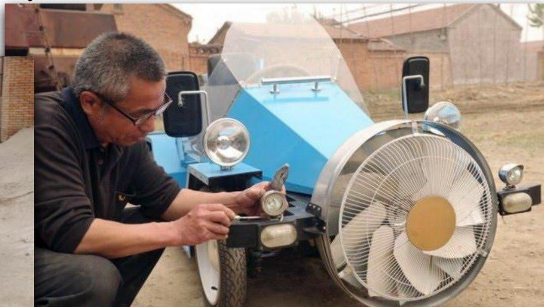
Источник подзарядки для электрогенераторов и аккумуляторных батарей, на которых работает экомобиль, - большой вентилятор, установленный в передней части машины. Крылья чудо-авто оснащены солнечными батареями, что служит дополнительным источником энергии. Принцип работы экомобиля прост: пока одна пара электрогенераторов работает, другая - подзарядается. Это обеспечивает бесперебойную работу транспортного средства.
