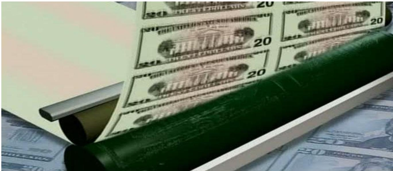
На этом этапе изготовления денег в ход идут оптические сканеры. Сканеры создают изображение каждой банкноты с двух сторон и выискивают мельчайшие изъяны. Процесс проверки денег на удивление быстр и точен - на проверку каждого листа нужна секунда.
