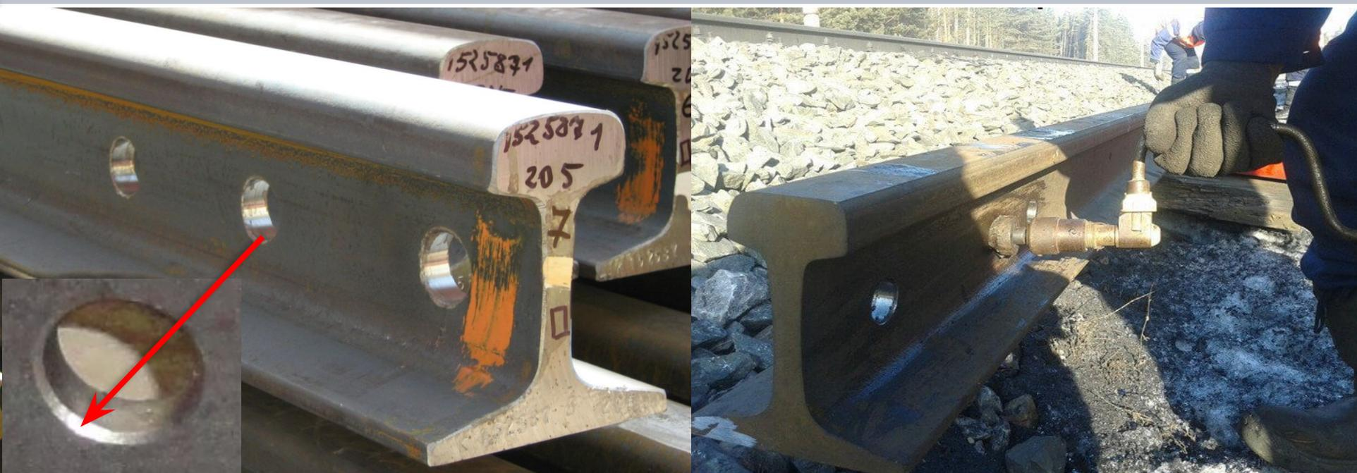
Болтовые отверстия рельсов диаметром 36 и 22 мм должны иметь фаски размером от 1,5 до 3,0 мм снятые под углом около 45 градусов.
