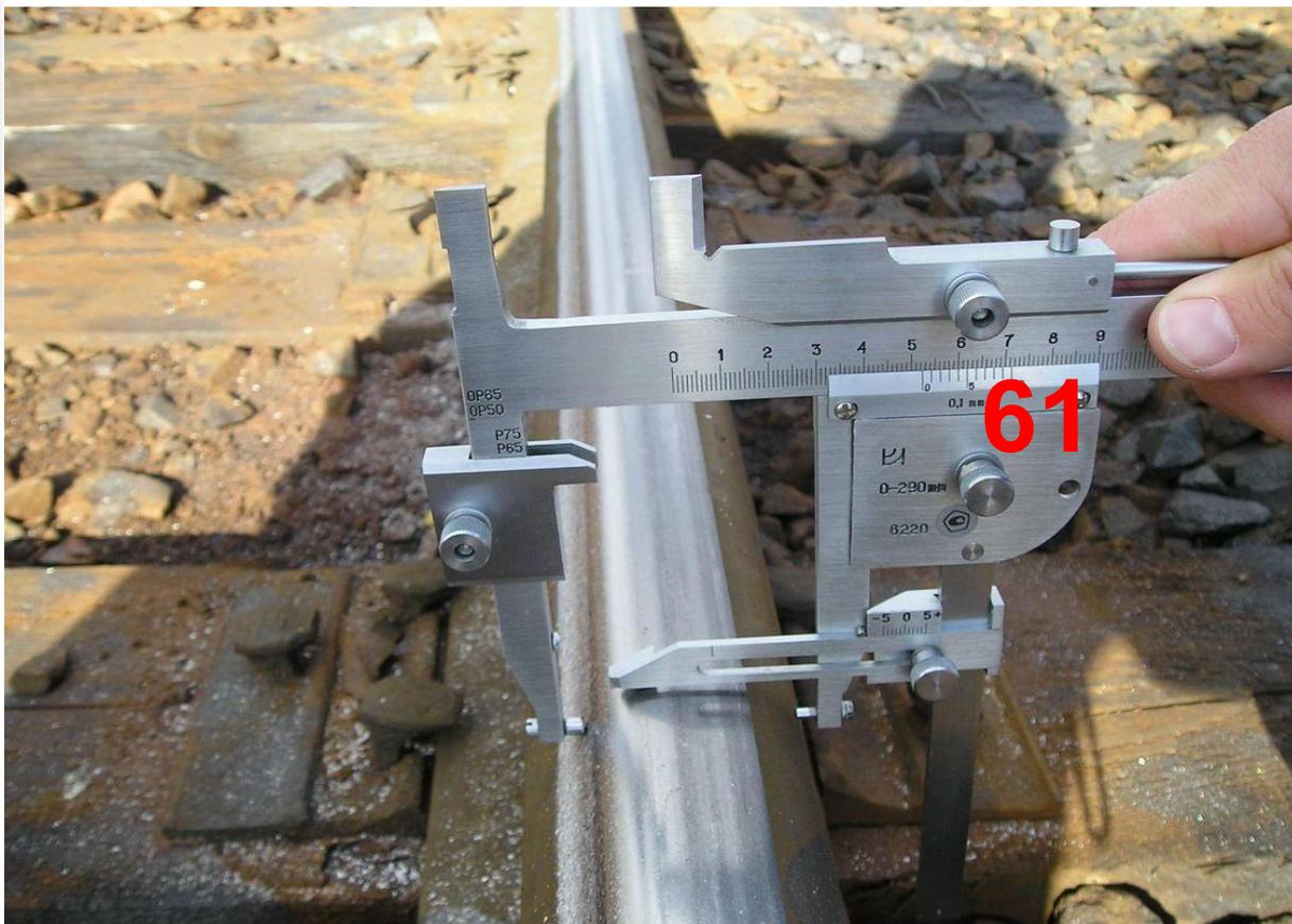
При определении бокового износа головки рельса расчет ведется от ширины новой головки рельса на уровне 13 мм ниже поверхности катания 72,2 мм
