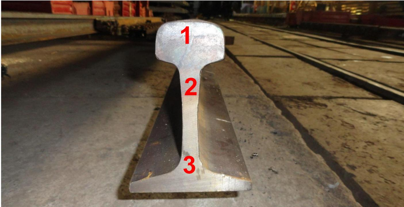
Рельс представляет собой несимметричную по горизонтальной оси двутавровую балку, в сечении рассматривается три элемента:
