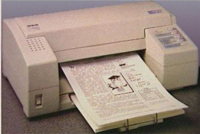
Головка печатающего устройства имеет *сопла*, через которые на страницу выбрызгиваются быстро-сохнувшие чернила. Мельчайшие капельки, достигнув бумаги, наносят требуемое изображение.
