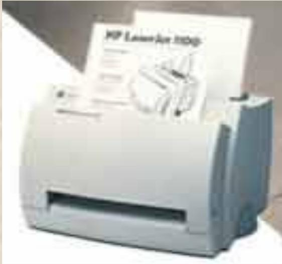
Информация проецируется с помощью лазерного луча на барабан со светочувствительным покрытием. Барабан при вращении проходит через контейнер, наполненный красящим составом (*тонером*), частицы которого налипают на засвеченные участки поверхности барабана. Принтер с помощью горячего валика протягивает
