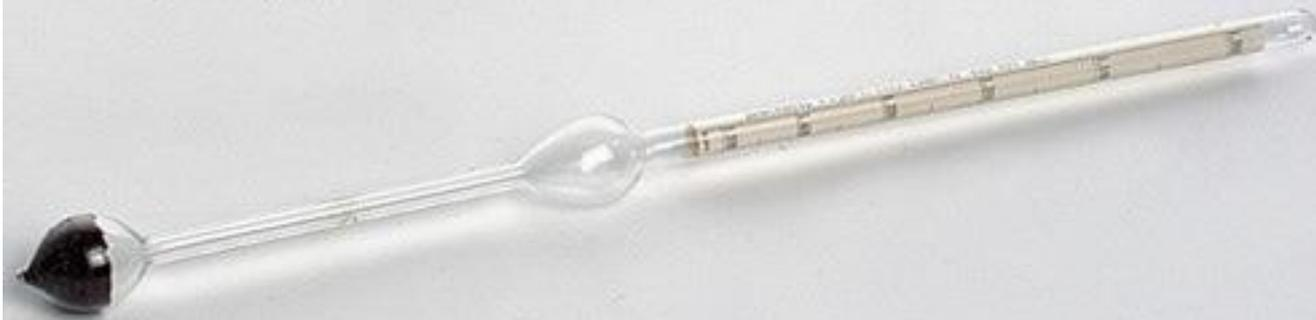
*Ареометр погружается в жидкость, плотность которой необходимо измерить. Принцип действия ареометра основан на законе Архимеда.*
