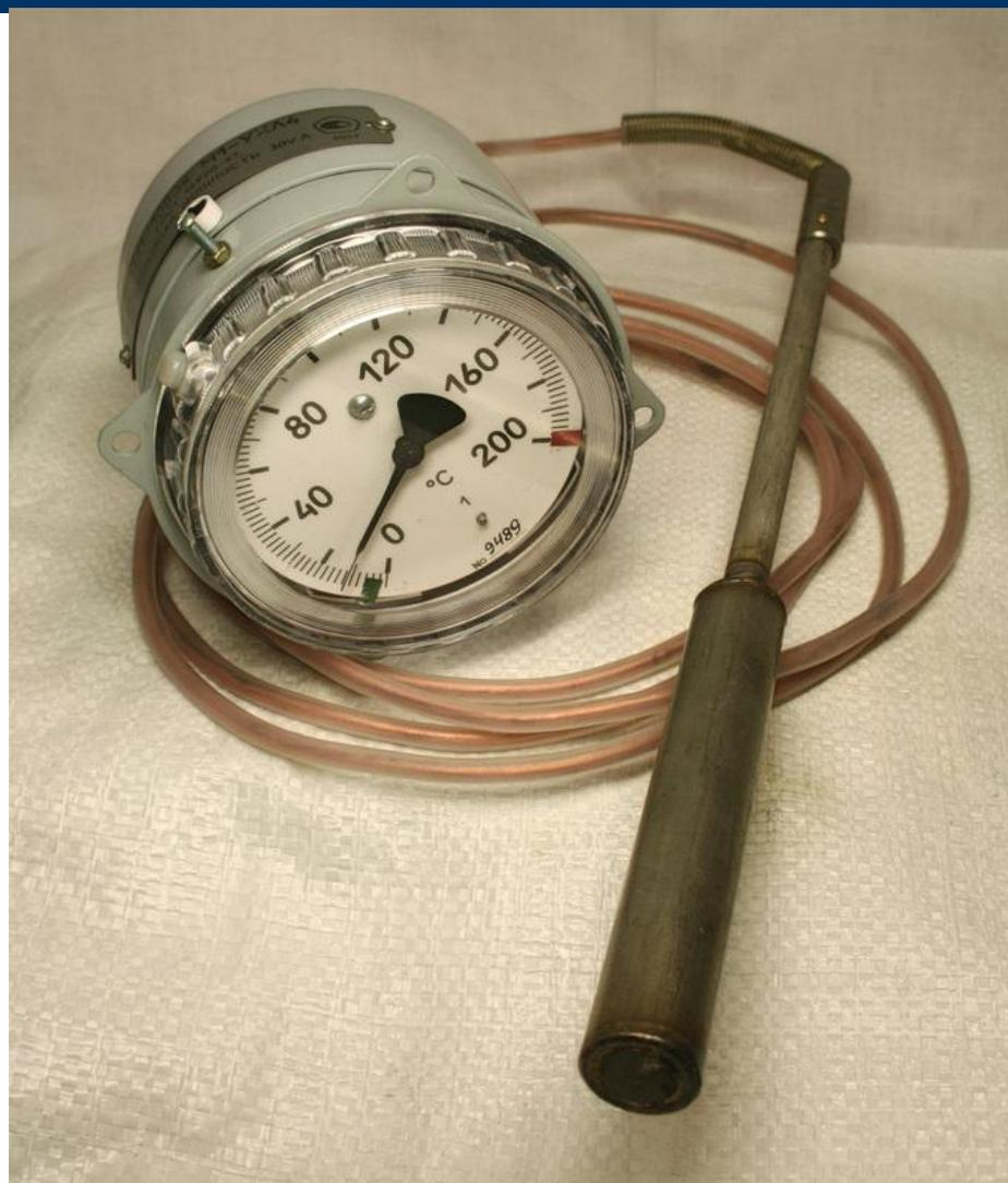
**В зависимости от заключенного в термосистеме рабочего вещества манометрические термометры разделяются на *газовые, жидкостные и конденсационные.***
