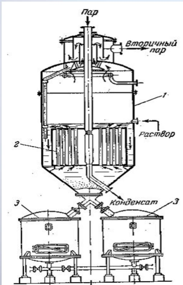
1 – корпус аппарата; 2 – нагревательная камера; 3 – нутч-фильтры
