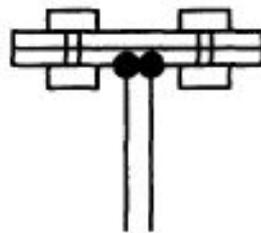
Расчет соединений ведется на силу сдвига пояса относительно стенки и местное давление от внешней нагрузки, приложенной к поясу балки
