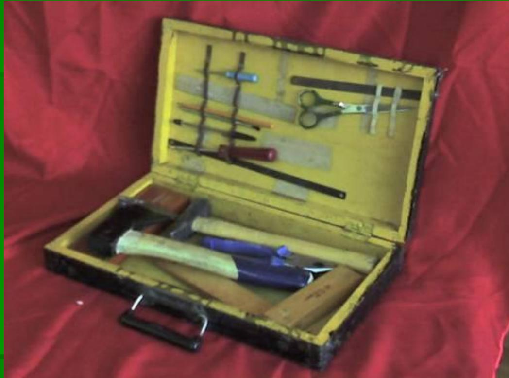
**-укладка-чемодан, предназначена для переноски необходимых инструментов. При переноске закрывается, что обеспечивает сохранность содержимого и оберегает от травм**
