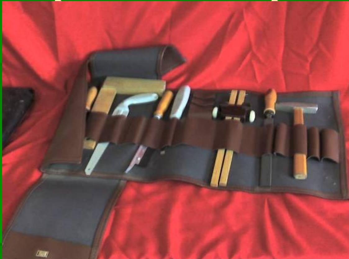
**-вариант укладки из тканевой основы, имеет много ячеек для размещения инструмента, компактный, легкий, но большой инструмент**
