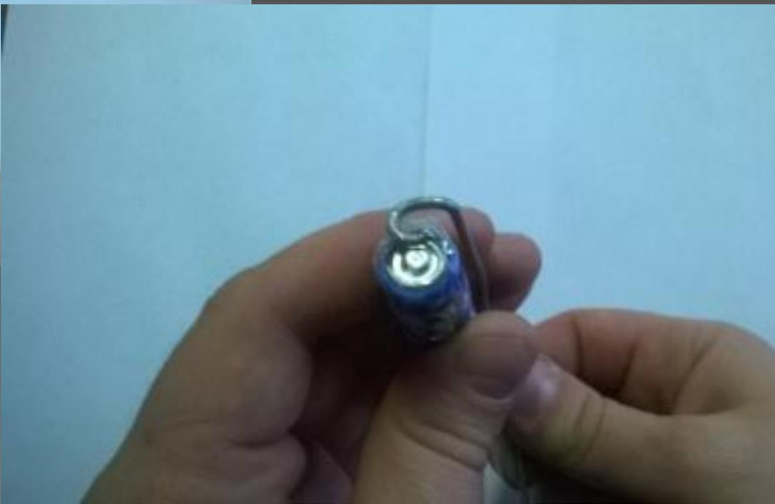
**С помощью пассатижей, на конце алюминиевой проволоке формируем круг, примерно равный диаметром плюсового контакта батарейки**
