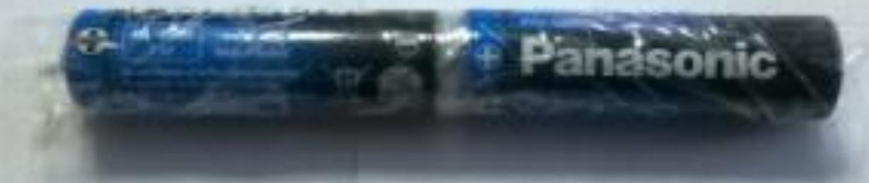
**Чтобы не повредить изоляцию батарейки и для лучшей фиксации, обматываем полностью две батарейки скотчем**
