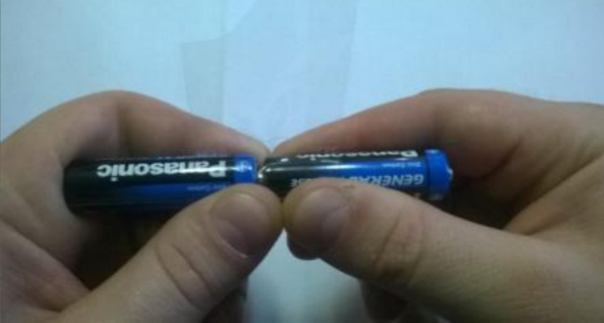
**Соединяем батарейки, плюс к минусу и фиксируем скотчем**
