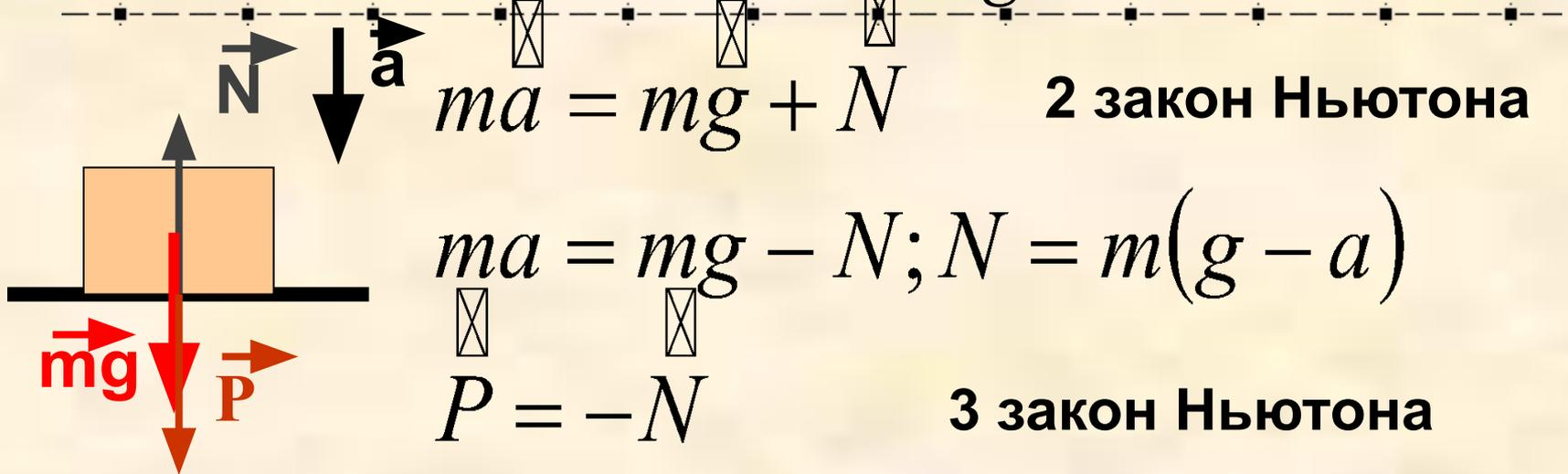
$$ma = mg + N \quad \text{2 закон Ньютона}$$
