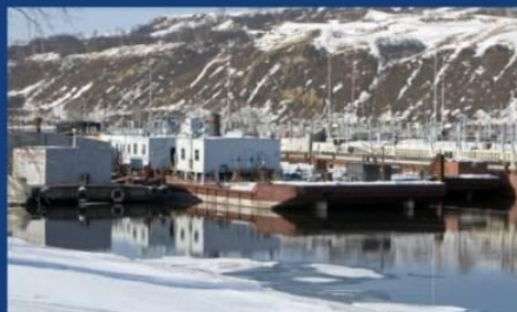
очистная станция для механизированной зачистки нефтеналивных барж
