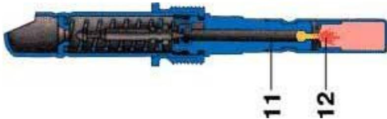
Пороховой состав замедлителя прогорел, срабатывает капсуль - детонатор
