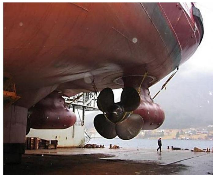
Один из примеров использования AZIPOD - танкер двойного действия, который на открытой воде движется как обычное судно, а во льдах движется кормой вперёд как ледокол. Для ледового плавания кормовая часть DAT оснащена ледовым подкреплением для ломки льда и AZIPOD.
