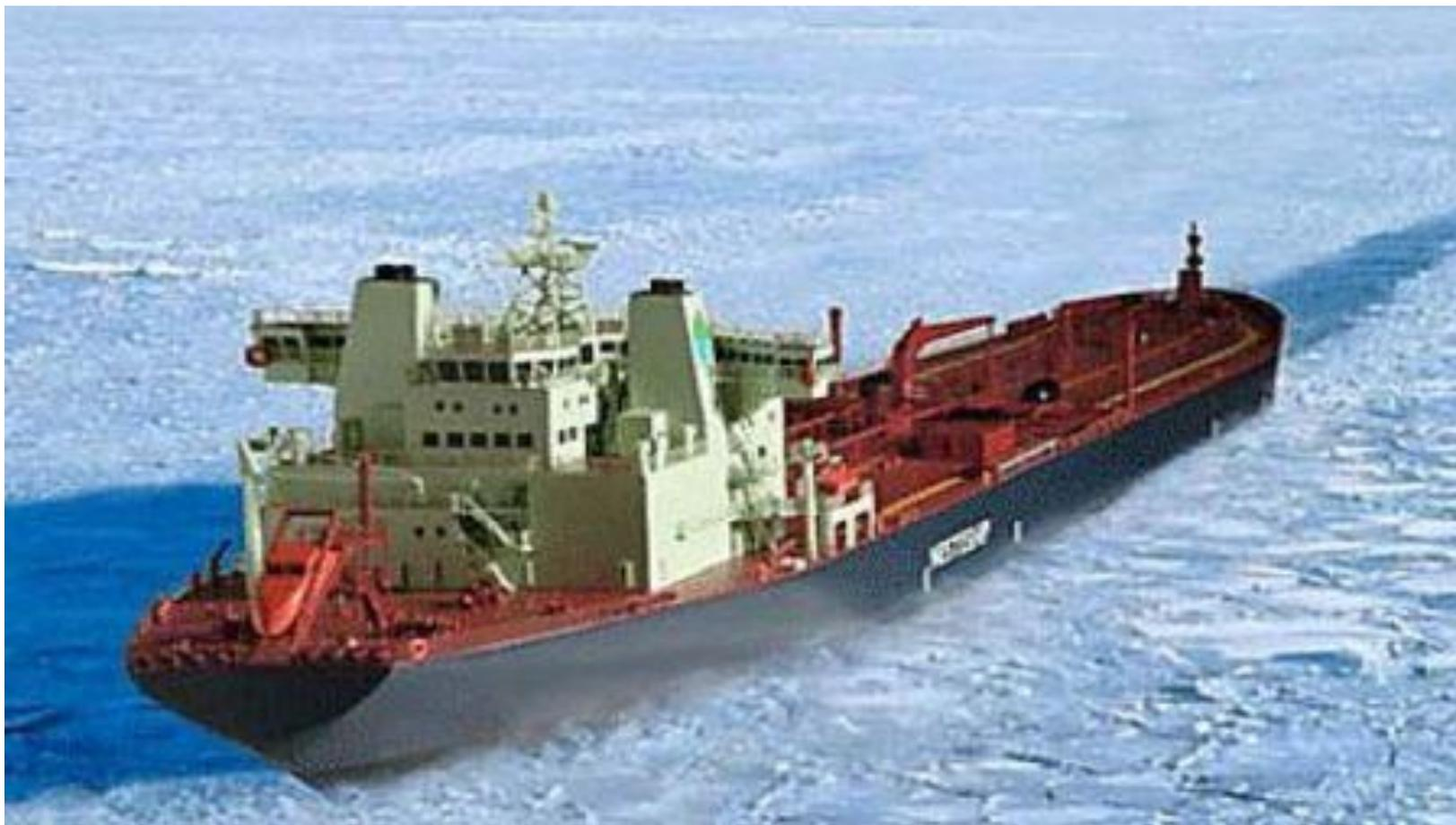
**Танкер двойного действия – Double Acting Tanker (DAT) TEMPERA**
