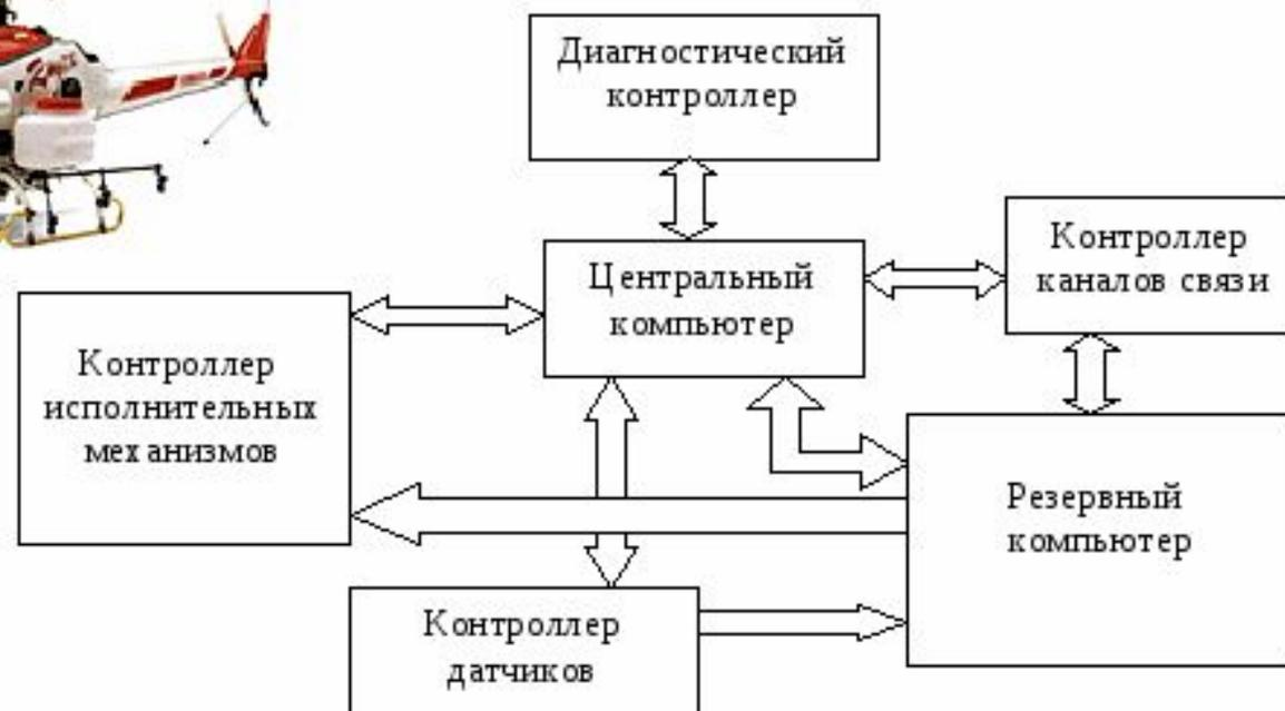
Рис. 3. Автономный вертолет Yamaha R-MAX и структура его системы управления
