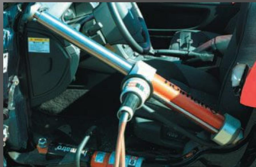
*Разрез каркаса сделан до начала работы домкрата*
