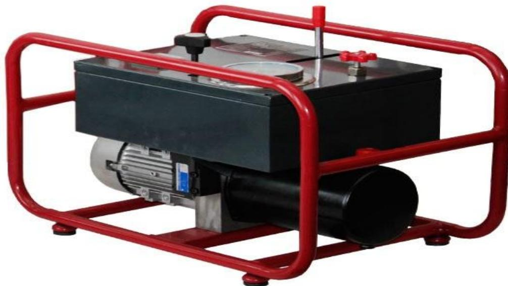
Сварочный аппарат с гидравлическим приводом предназначен для выполнения сварочных работ, могут использоваться, как силовые генераторы для питания потребителей электрическим током. Сила тока сварочного аппарата 40-300А, диаметр сварочного электрода 4-5 мм.
