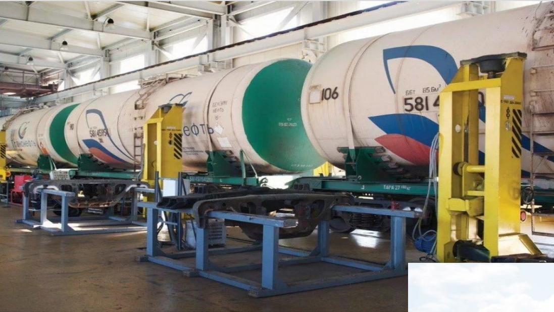
**Поддержание цистерн в работоспособном состоянии обеспечивается системой технического обслуживания и периодических ремонтов. Заключается техническое обслуживание в осмотре и устранении неисправностей.**
