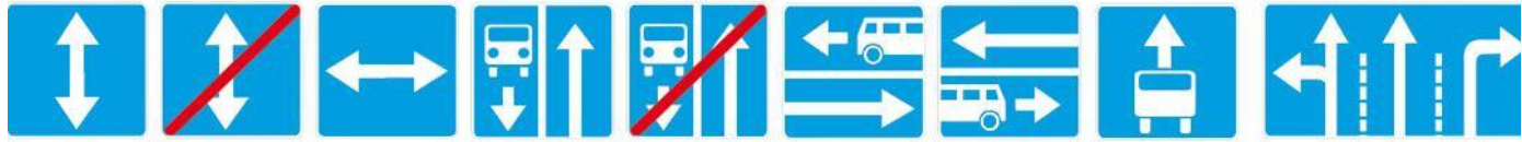
5.8 Реверсивное движение 5.9 Конец реверсивного движения 5.10 Выезд на дорогу с реверсивным движением 5.11 Дорога с полосой для маршрутных транспортных средств 5.12 Конец дороги с полосой для маршрутных транспортных средств 5.13.1 Выезд на дорогу с полосой для маршрутных транспортных средств 5.13.2 Выезд на дорогу с полосой для маршрутных транспортных средств 5.14 Полоса для маршрутных транспортных средств 5.15.1 Направление движения по полосам
