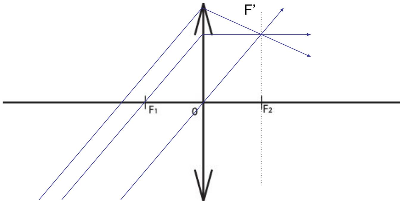
Все лучи, параллельные побочной оптической оси, проходя через линзу, пересекаются в фокальной плоскости (побочном фокусе)
