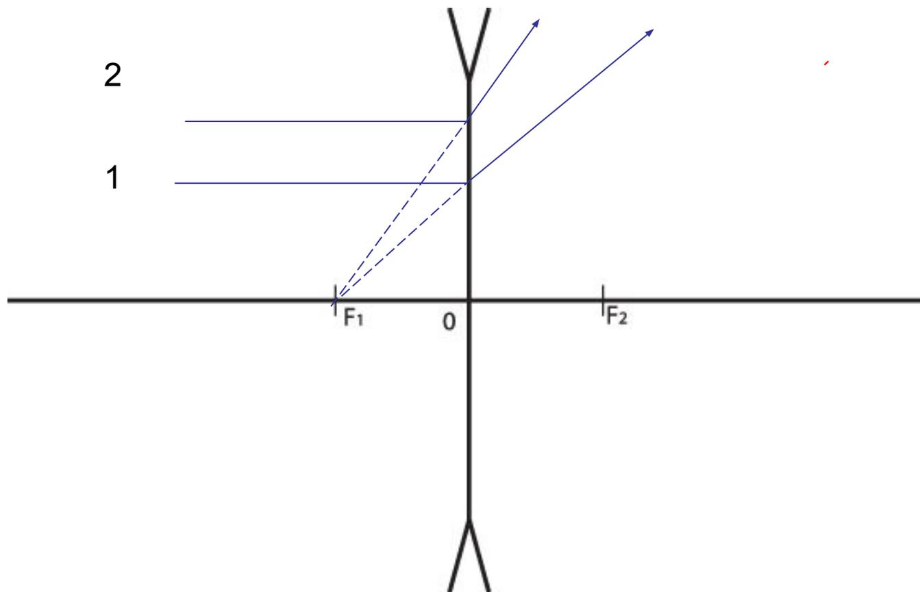
Все лучи, которые проходят параллельно главной оптической оси, преломляются, а их мнимое продолжение пересекается в фокусе линзы.
