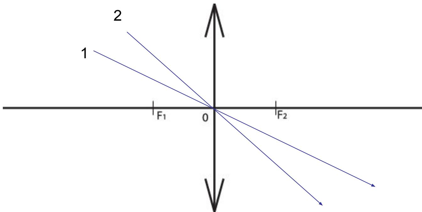
Все лучи проходящие через оптический центр линзы не преломляются и являются побочными оптическими осями.
