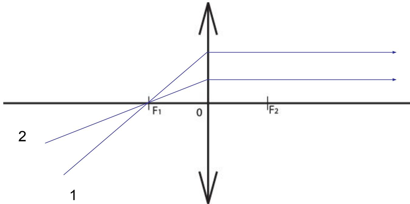
Все лучи, которые проходят через фокус, преломляются в линзе и выходят параллельно оптической оси
