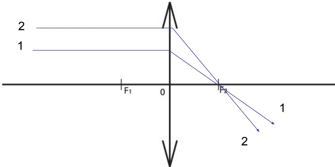
Все лучи, которые проходят параллельно главной оптической оси, преломляются и пересекаются в фокусе линзы.
