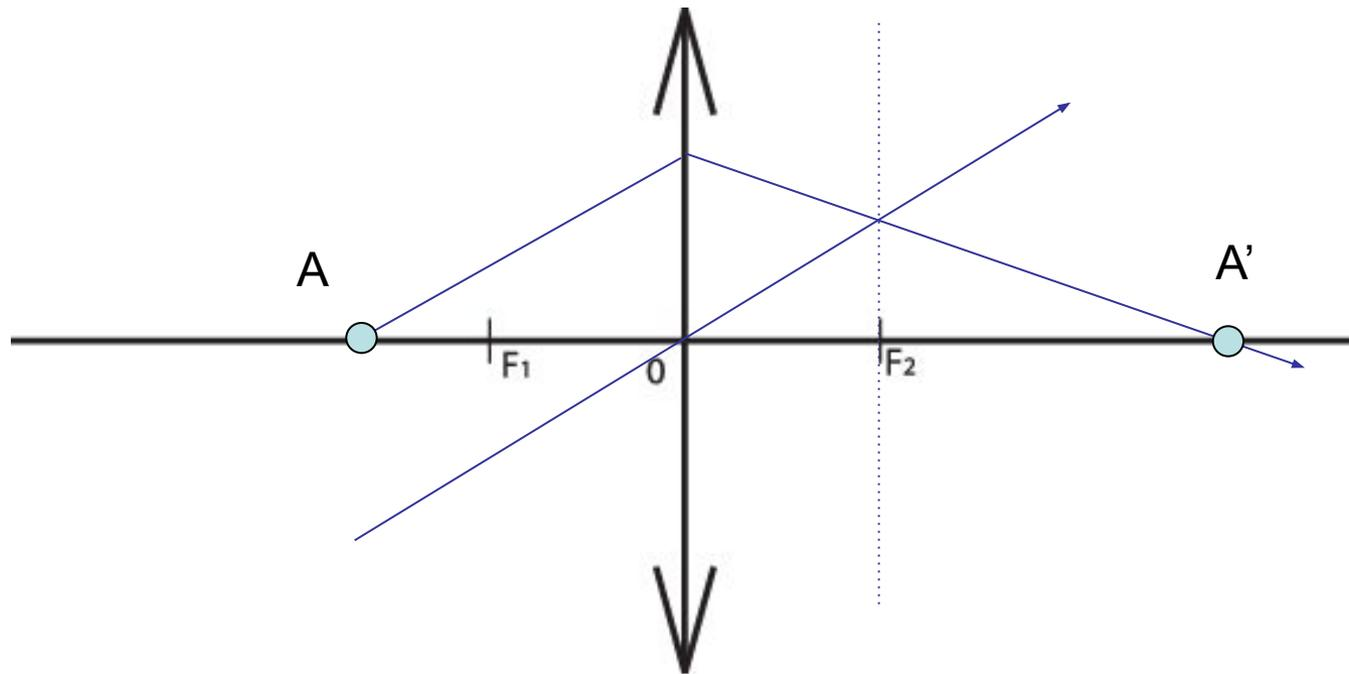
Для построения точки на главной оптической оси необходимо выбрать побочную оптическую ось.
