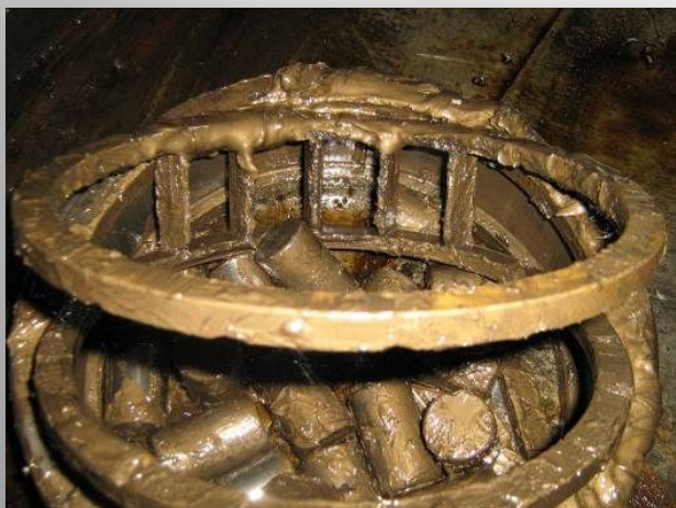
Разрушенный из-за перегрева буксовый подшипник качения
